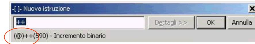
L'istruzione '++' viene eseguita ad ogni scansione se il segnale di abilitazione è ad ON
